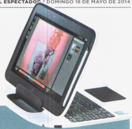
El dispositivo dos en uno pesa menos de 1 kg, está equipado con una pantalla de 10 pulgadas y tiene un procesador Intel® Atom™ Z3740D.
